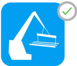
Las losas deben ser izadas con el equipo adecuado. Se pueden utilizar pinzas especiales para su izado u otro dispositivo que asegure la integridad de la pieza prefabricada. La Placa Semi-Alveolar tiene un sistema propio de izado a base de pasadores que aseguran una correcta manipulación.
