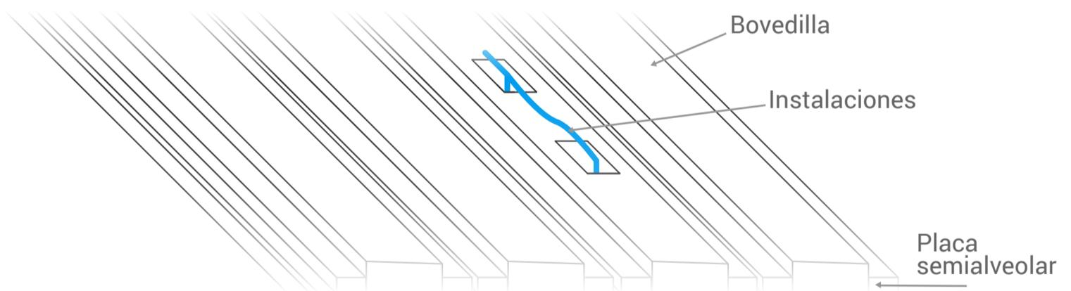
Previa autorización del personal técnico de Grupo Previ, se permite hacer orificios en el patín para pasar instalaciones a través de este. Estos orificios deben ser especificados por el Personal Técnico de Grupo Previ y no exceder del diámetro permitido, de tal forma que no se afecte de ninguna manera la capacidad estructural de la losa.
