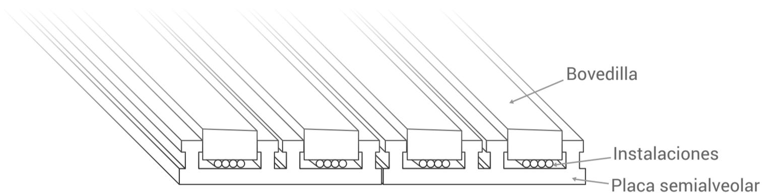
Dependiendo del espesor del firme, se permite instalar ductos hasta cierto diámetro. Se recomienda que el diámetro del ducto no rebase el 30% del espesor del firme.
